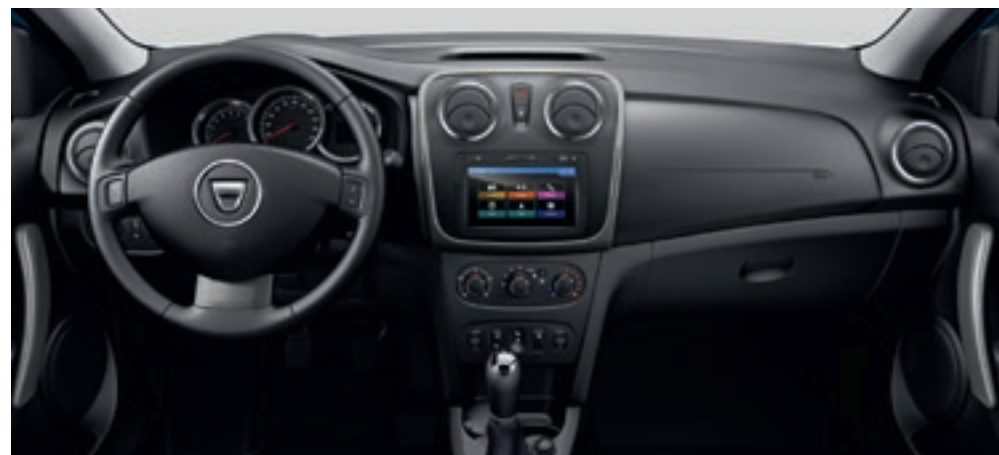
Palubná doska verzie Stepway s multimediálnym navigačným systémom Media Nav Evolution s dotykovou 7" obrazovkou (za príplatok), tempomatom s obmedzovačom rýchlosti.
